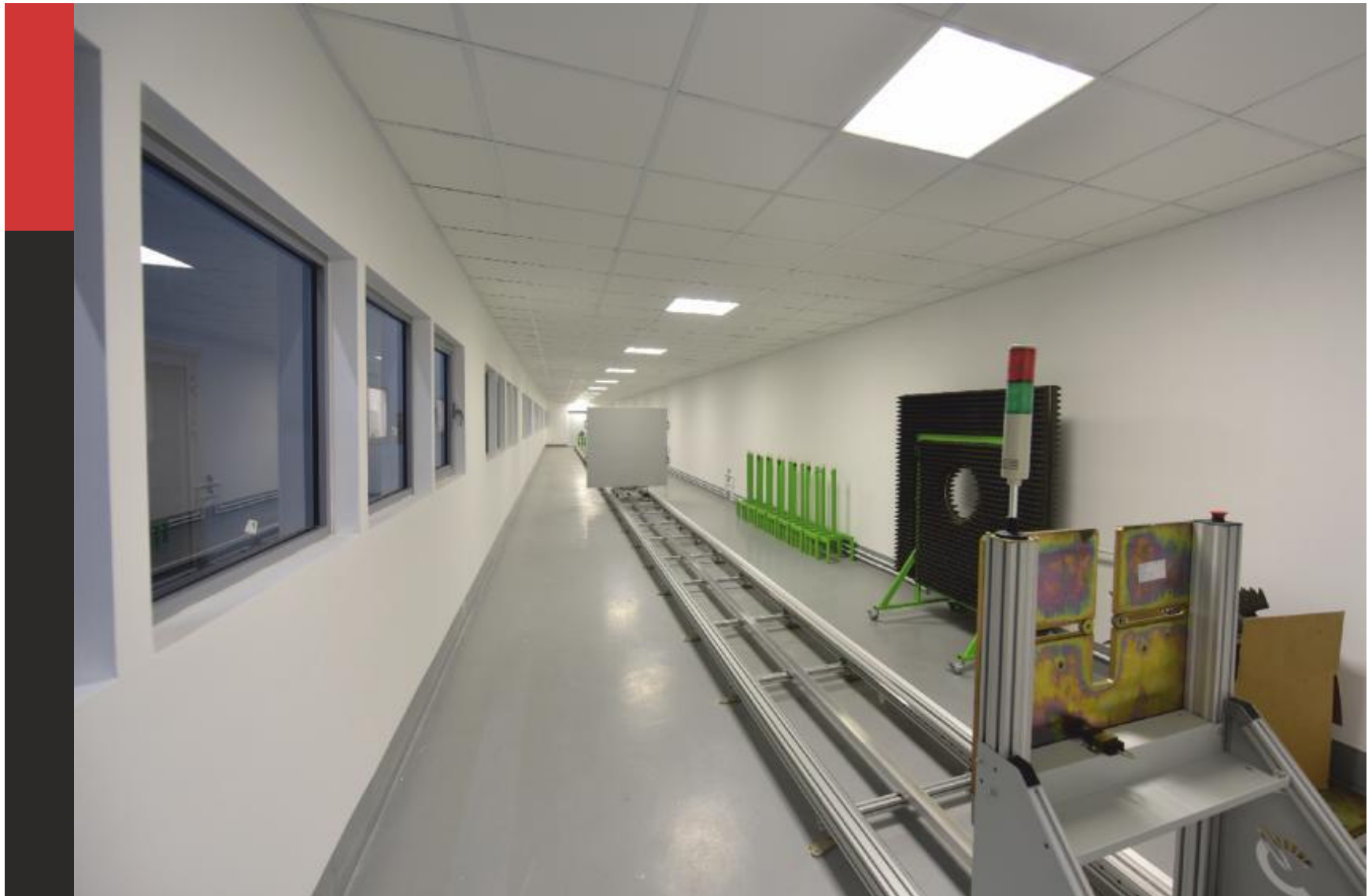
Метрологический стенд для проверки калибровки и датчиков уровня жидкости
