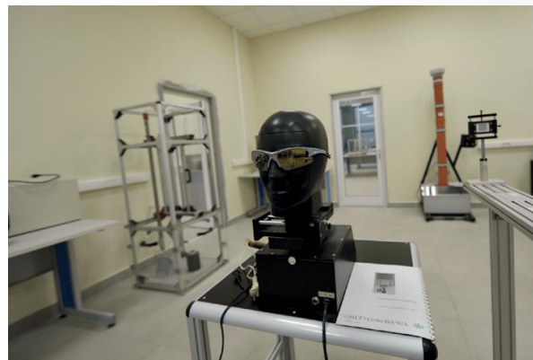
Стенд для определения сферической рефракции, астигматизма и призматического действия зрительных элементов СИЗ.
